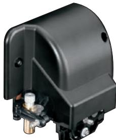
Su simplicidad ha hecho de la tecnología de la **cuchilla de arrastre** (o cuchilla giratoria) la más comúnmente utilizada. Un parámetro offset define la distancia entre la punta de la cuchilla y el centro de rotación. Para conocer la posición de la cuchilla que rota libremente dentro del portacuchillas, se realiza un movimiento de arrastre, asumiendo que la punta de la cuchilla lo seguirá
