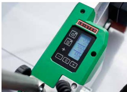
Parámetros de soldadura regulados
